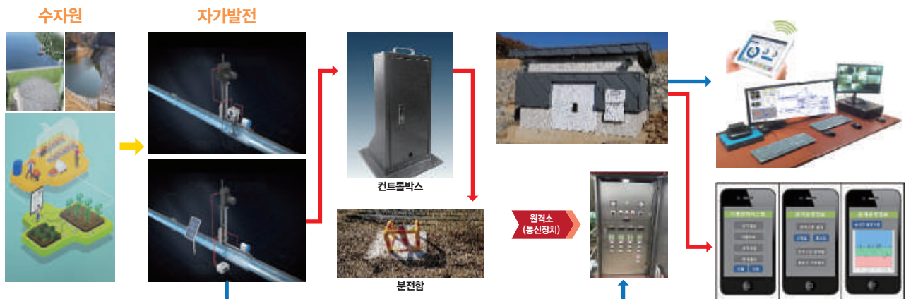
자가발전형(소수력, 태양광) 관개장비 원격제어시스템 구성도
