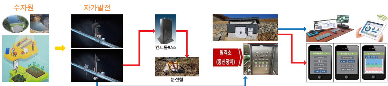
자가발전형(소수력, 태양광) 관개장비 원격제어시스템 구성도
